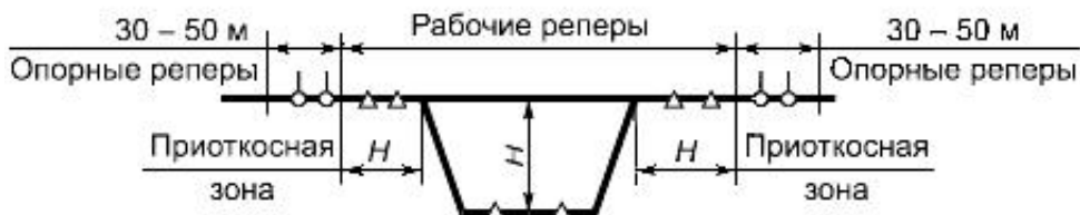
б) Разрез сооружения
